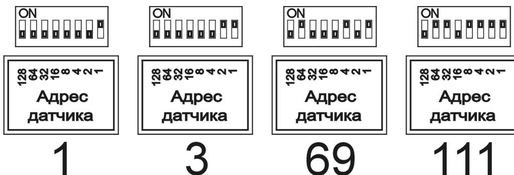
Рис.12.2. Примеры установки различных Modbus адресов.
