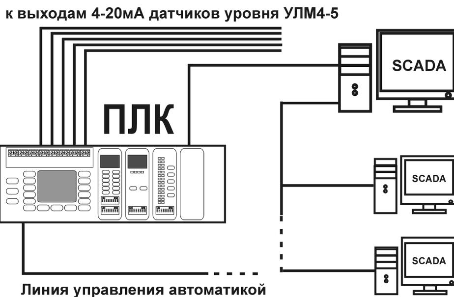
Рис.17.4. Подключение УЛМ31-А2 к ПЛК АСУТП через токовые входы.
